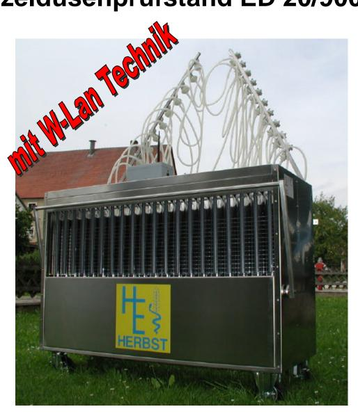
Prüfstand zur Kontrolle des Flüssigkeitsausstoßes einzelner Düsen an Sprühgeräten, Bandspritzen und Sonderkulturspritzgeräten.
