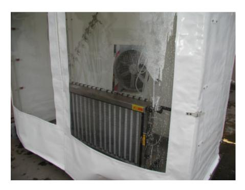
L'utilizzo della camera per il controllo visivo permette di osservare gli ugelli senza che il liquido di prova finisca nell'ambiente.
