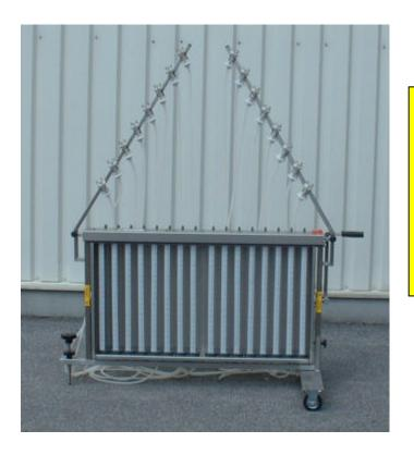
Solido telaio in acciaio inossidabile su ruote per facilitare il trasporto.
