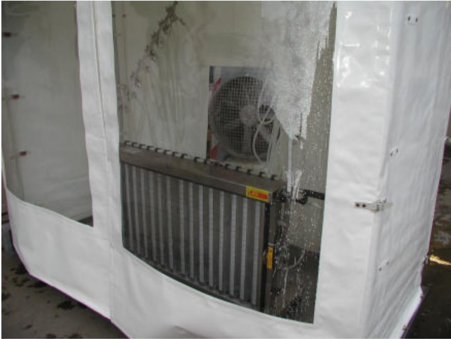
Bei Verwendung der Sichtkammer können die Düsen beobachtet werden, ohne dass Prüflüssigkeit in die Umwelt gelangt. Große Fensterflächen auf der Prüferseite, leicht zerlegbar, auf Rollen leicht über den Prüfling montierbar und die Möglichkeit der Kombination mit dem ED Kipp sind die Vorteile dieses Gerätes.
