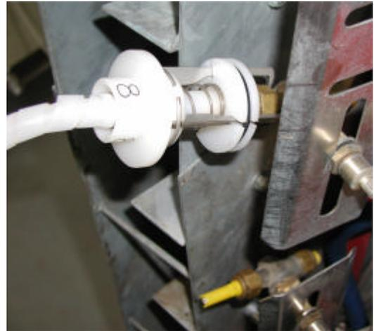
Diese Düsenadapter ermöglichen einen schnellen Anschluß der Meßschläuche an die zu prüfenden Düsen.
