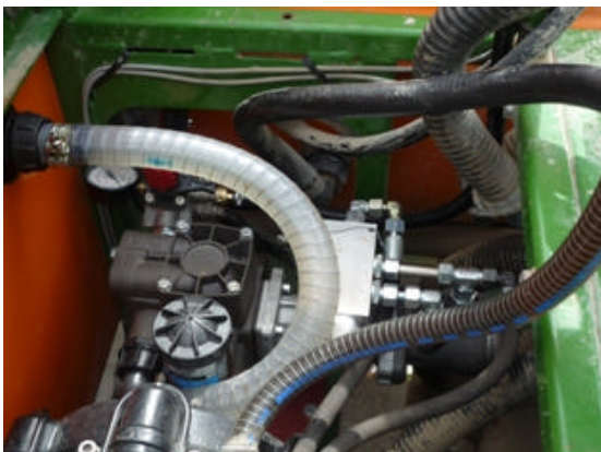
Einbaubeispiel einer hydraulisch angetriebenen Pumpeneinheit
